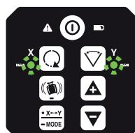
☞ El LED de eje X se muestra intermitente tres veces, luego se ilumina de forma intermitente lentamente hasta la nivelación. Cuando el SKR001 esté nivelado, el LED del eje X se iluminará sin parpadear.
