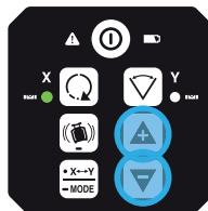
3. Pulsar la tecla de modo X/Y para cambiar al eje Y.
