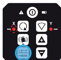
☞ Modo de inclinación de eje doble, X inclinado, Y inclinándose:
