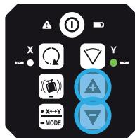
2. Continuar pulsando las teclas de desplazamiento hacia arriba y hacia abajo y controlar el punto hasta que el SKR001 se encuentre dentro del rango especificado.
