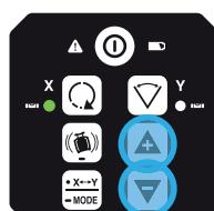
☞ Un parpadeo del LED del eje X y un pitido indican el cambio de un incremento.
